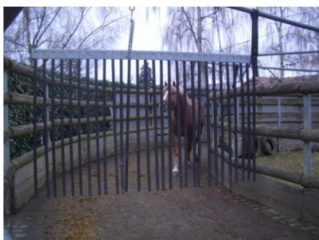
Figure 36 Longe automatique avec séparations pouvant être électrifiées (Photo : Haras national suisse)
