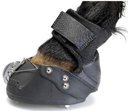
Figure 12 Pantoufle en polyuréthane. On l'emploie en remplacement ou en complément du ferrage, ainsi que pour protéger un pied (principalement sa sole) blessé, fragilisé ou en cours de traitement (source : Armée suisse — documentation — la maréchalerie militaire 64.010 f, avec l'aimable autorisation du colonel S. Montavon, Service vétérinaire de l'armée suisse)
